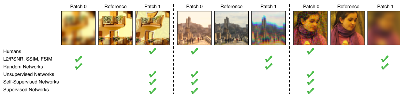
图 1: 在这些例子里, 哪个图块 (左边还是右边) 与中间的图块 “更接近”? 每一组中, 传统度量 (L2/PSNR、SSIM、FSIM) 都与人类判断相左。然而深度网络——即便横跨不同架构 (SqueezeNet [20]、AlexNet [27]、VGG [52]) 与不同监督类型 (监督 [47]、自监督 [13, 40, 43, 64], 乃至无监督 [26]) ——却都能给出一种涌现的嵌入, 与人类判断出奇地吻合。我们进一步在一个大规模感知判断数据库上对已有的深度嵌入加以校准; 模型与数据参见 https://www.github.com/richzhang/PerceptualSimilarity 。
