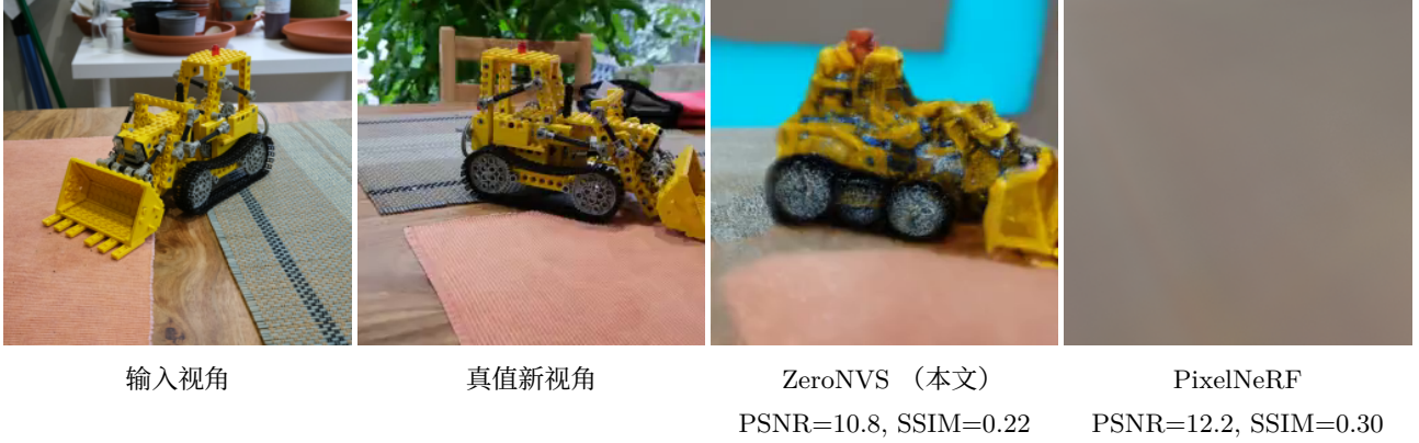
图 7. PSNR 和 SSIM 对于视角合成评估的限制。不对齐可能导致语义上更合理的预测获得更差的 PSNR 和 SSIM 值。
